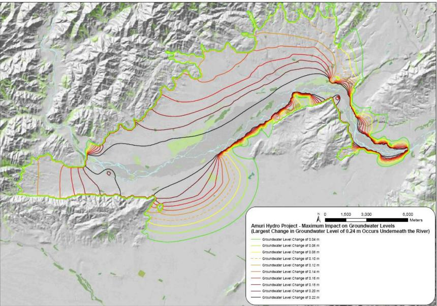
ATTACHMENT E - GROUNDWATER LEVEL CHANGES FOR THE HYDRO ABSTRACTION IS 50 m<sup>3</sup>/s
